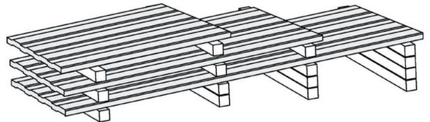
Werksseitige Verpackungen müssen an den Enden geöffnet werden, um eine Kondensatbildung zu vermeiden. Bei unsachgemäßer Lagerung und unzureichender Belüftung kann sich Weißrost bilden. Eine geringfügige Weißrostbildung stellt noch keinen mindernenden Mangel in Hinsicht auf die Gebrauchsfähigkeit des Materials wieder.
